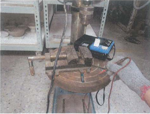
絕緣電阻值量測。
