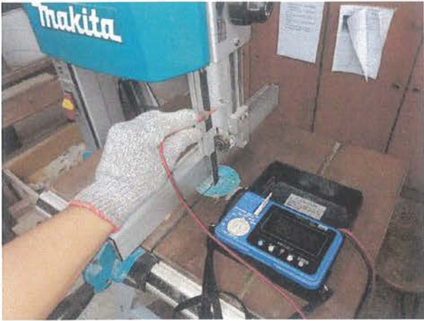
絕緣電阻值測試。
