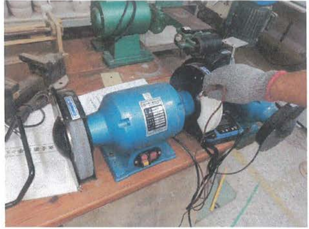
絕緣電阻值量測。
