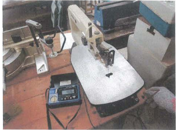
絕緣電阻值量測。
