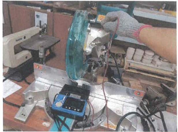
絕緣電阻值量測。
