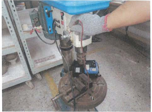
絕緣電阻值量測。
