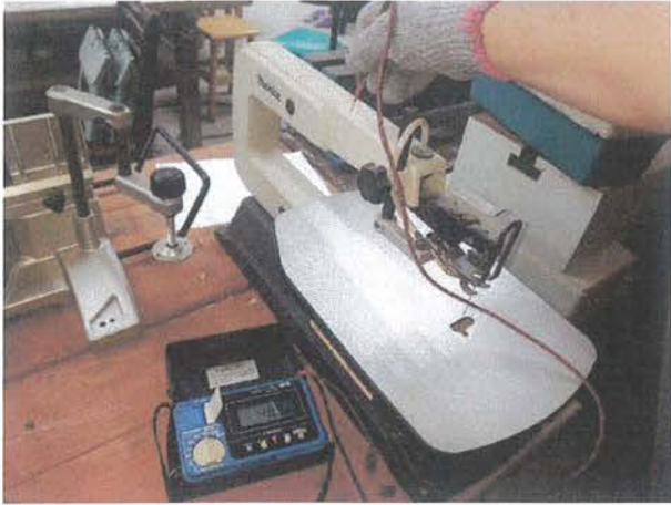
絕緣電阻值量測。
