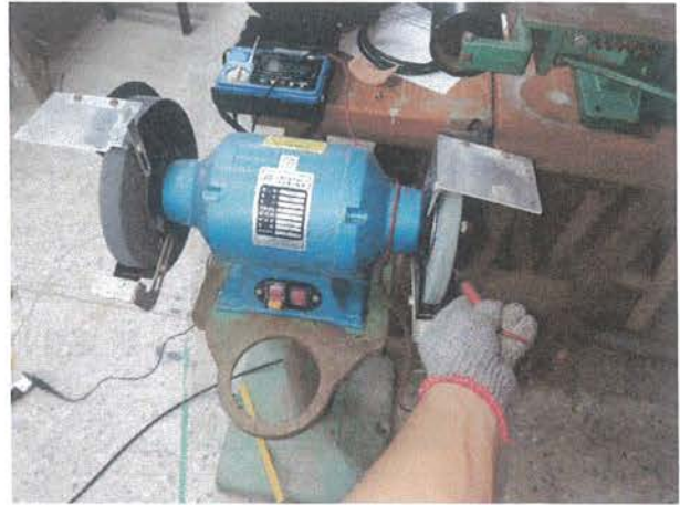
絕緣電阻值量測。
