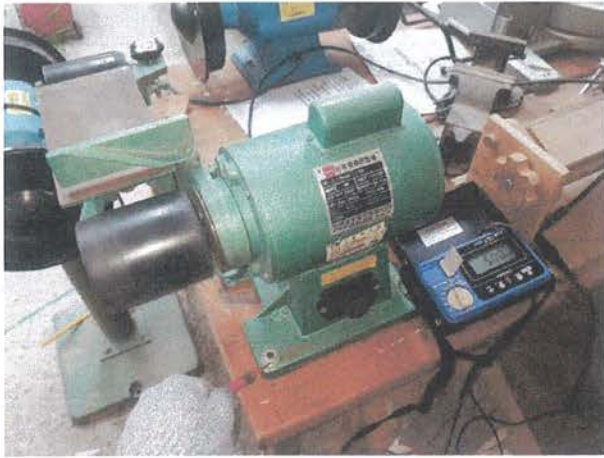
絕緣電阻值量測。
