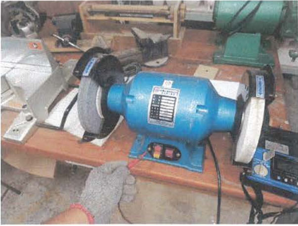
絕緣電阻值量測。
