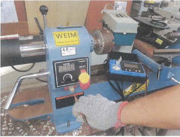
絕緣電阻值量測。
