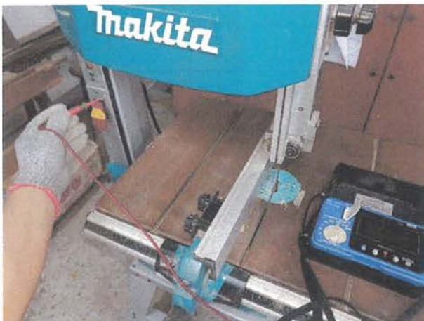
絕緣電阻值測試。
