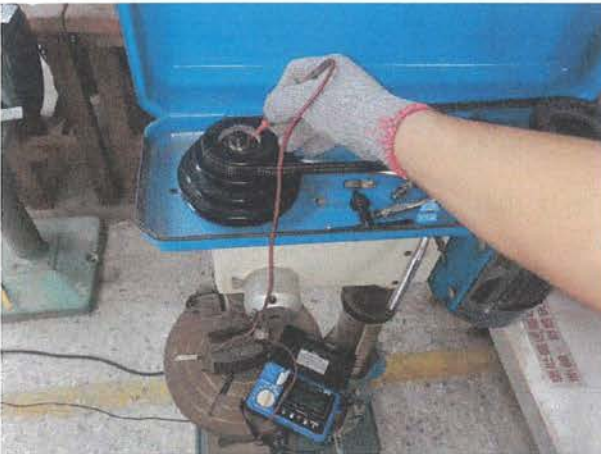
絕緣電阻值量測。
