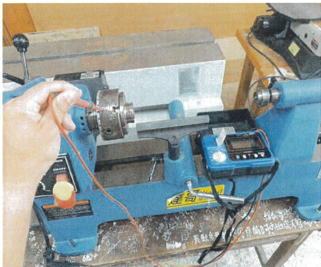
絕緣電阻值量測
