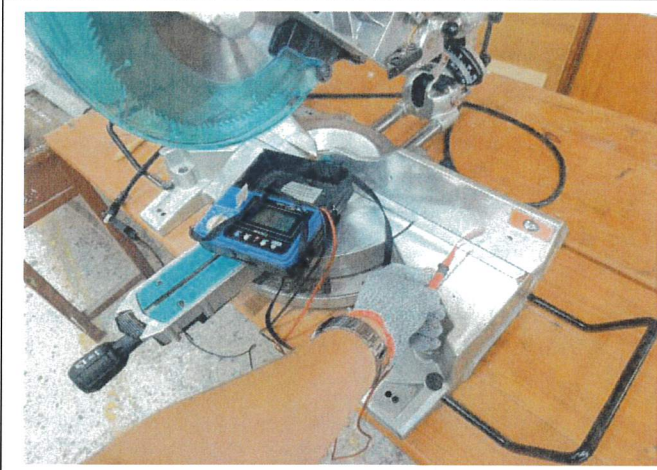
絕緣電阻值量測
