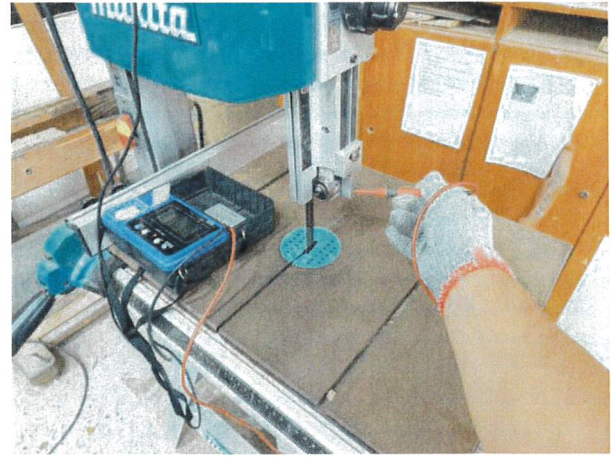
絕緣電阻值量測
