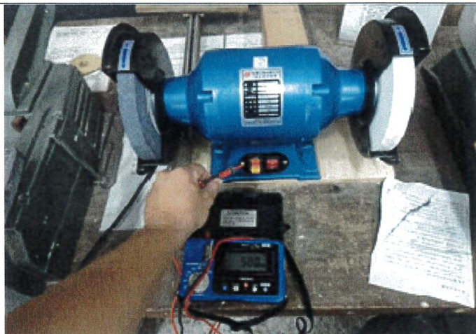
絕緣電阻值量測
