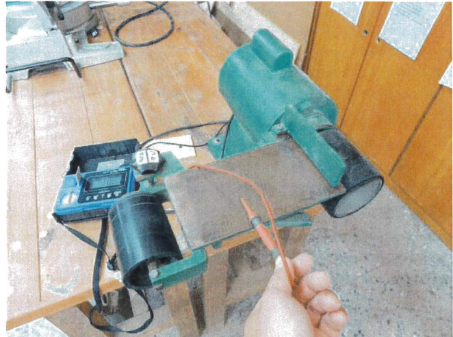
絕緣電阻值量測
