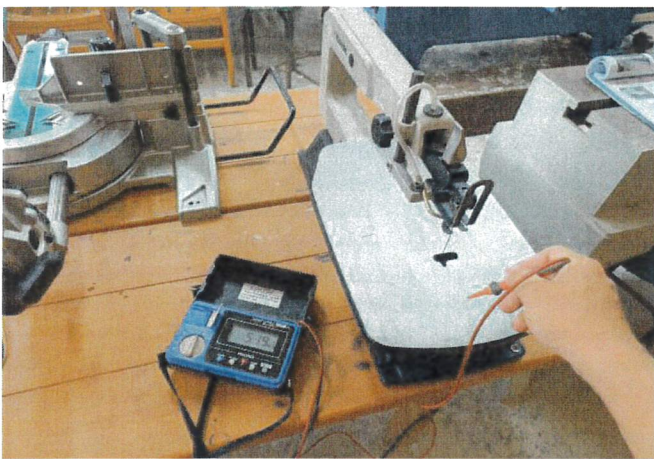
絕緣電阻值量測
