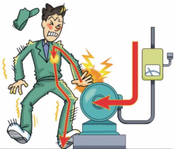
設備未接地及裝設漏電斷路器
